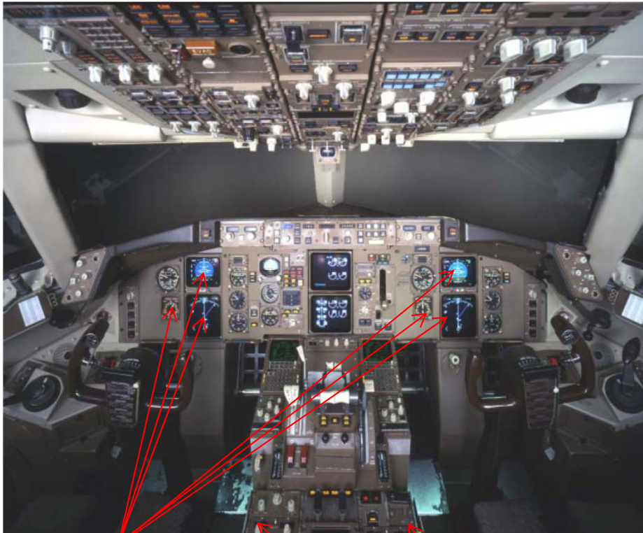
コックピット内の無線設備配置例
