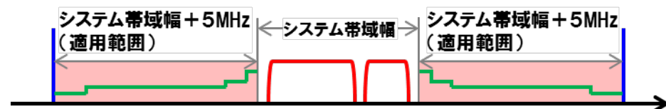
図: 陸上移動局のスペクトラムマスクの規定の適用範囲(同一周波数帯内の連続するCAの場合)
