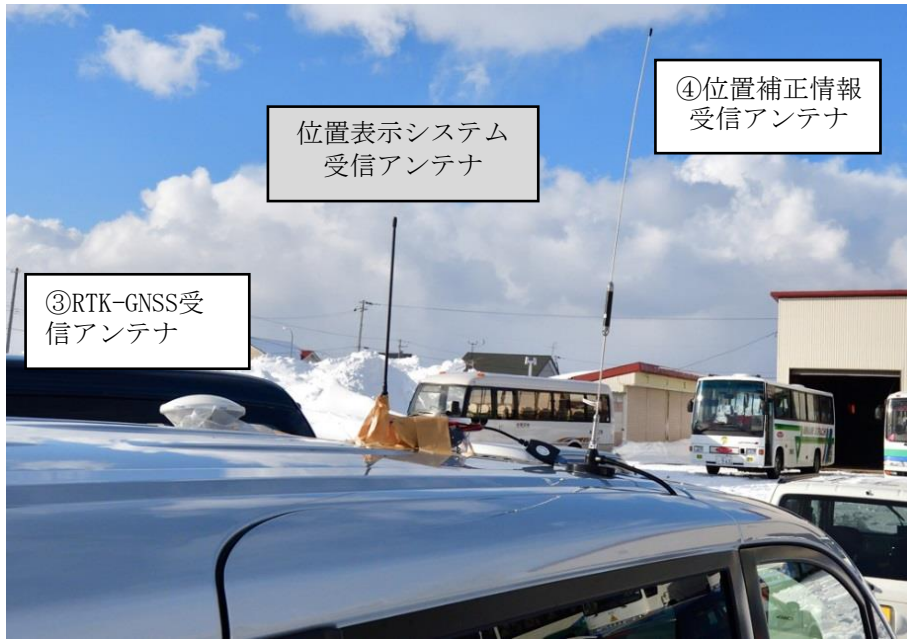
図 3-17 移動局機材（アンテナ設置状況：地上高約 2m）
