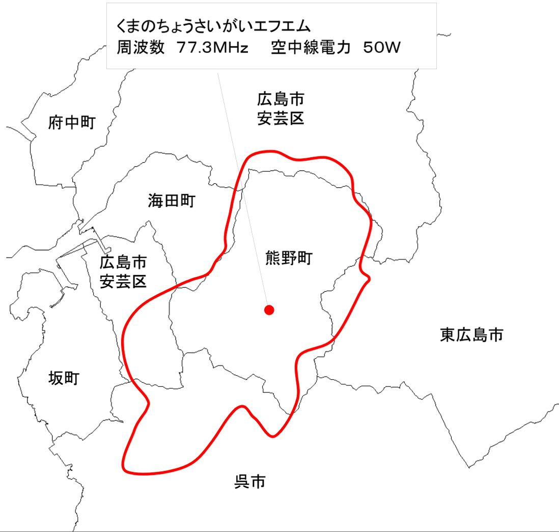
— 免許を付与した臨時災害放送局の放送エリアの目安 (0.25mV/m)
