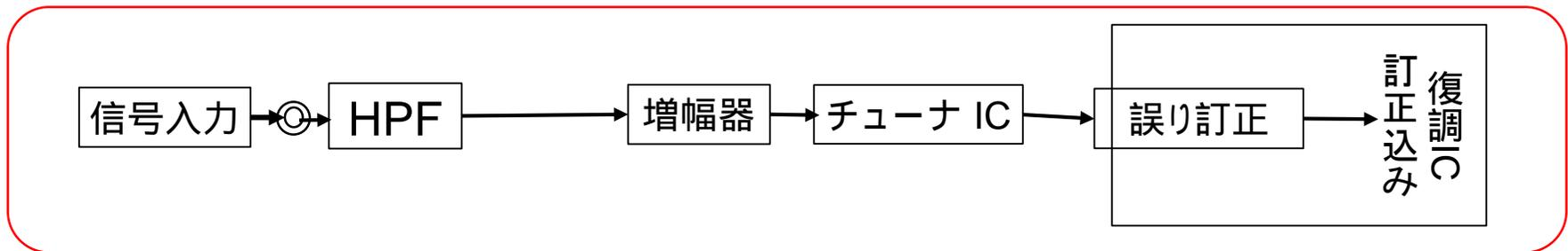
入力信号の分配回路を有したSTBの内部構成図(今回測定に使用したSTB)
