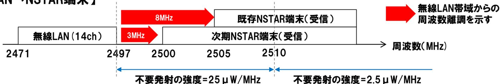
いずれも所要改善量が残り、帯域外干渉では約56mの、帯域内干渉では約80mの離隔距離が必要。
