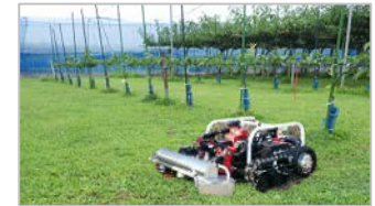
(明確な研究目標)導入しやすい 価格の自動除草ロボット
