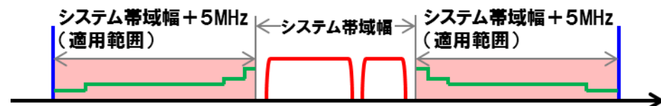
図: 陸上移動局のスペクトラムマスクの規定の適用範囲(同一周波数帯内の連続するCAの場合)
