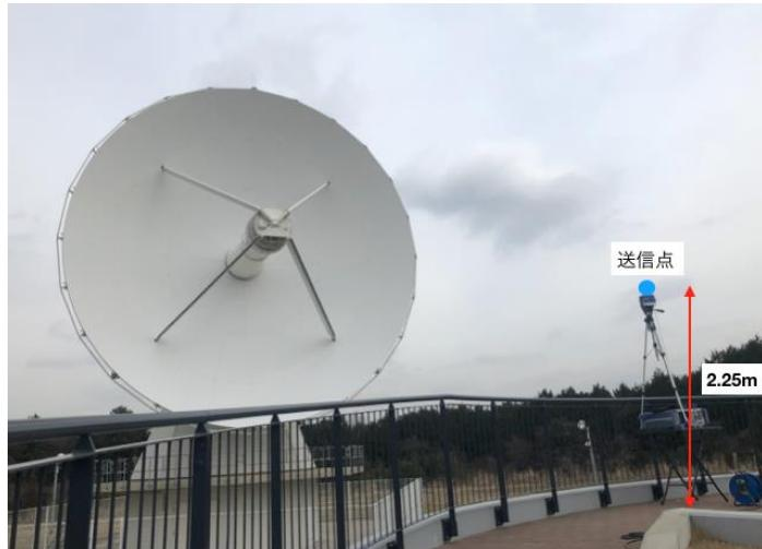
写真 5-4 石岡局測定点 Aにおいて送信アンテナをかさ上げした様子
