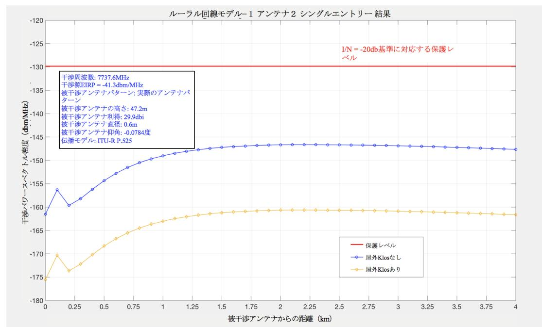
参図 1-9 ルーラル回線モデルー1 のアンテナ2に対するシングルエントリーシミュレーション結果
