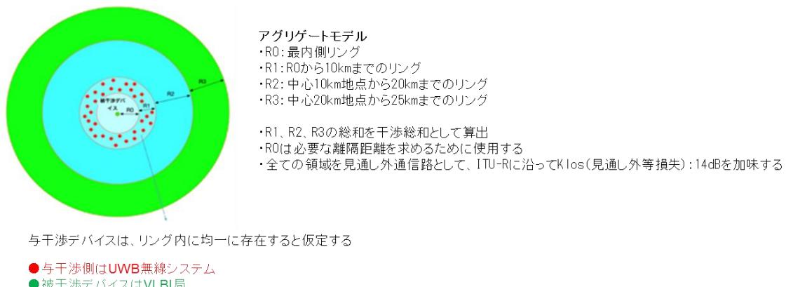
参考図 4-1 アグリゲートで用いたリングモデル
