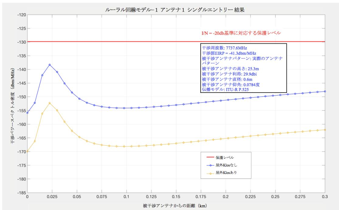
参図 1-8 ルーラル回線モデルー1 のアンテナ1に対するシングルエントリーシミュレーション結果
