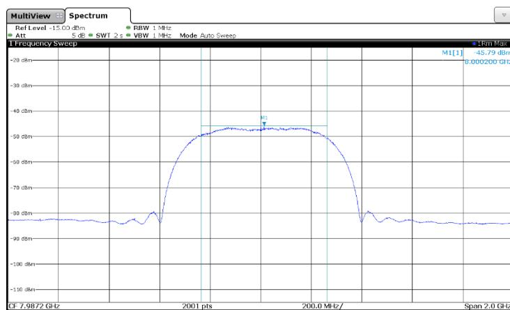
(注) 最大利得 4.5 dBi の試作アンテナに接続すると EIRP 換算で-41.29 dBm/MHz
