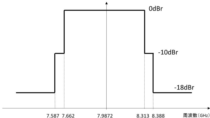
図2-9 IEEE802.15.4a-2007のチャネル9のPSDマスク
