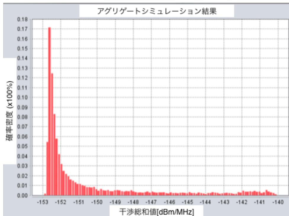
参図 1-14 都市部、100%屋外利用、アンテナ高さ 40m のアグリゲート結果
