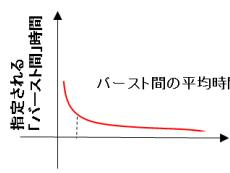
$$\text{アクティブ時のリンクレート}(\%) = \sum (\text{バースト時間}) / (\text{UWBオン時間})$$
