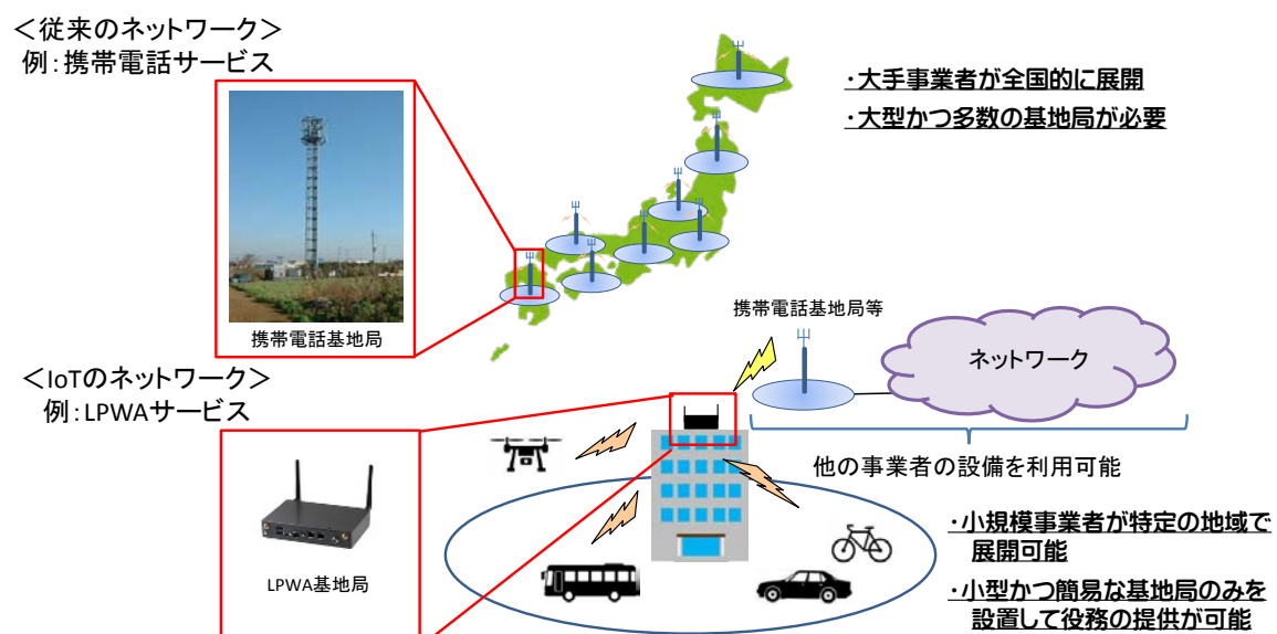
図 2.1 従来のネットワークと IoT のネットワークとの比較
