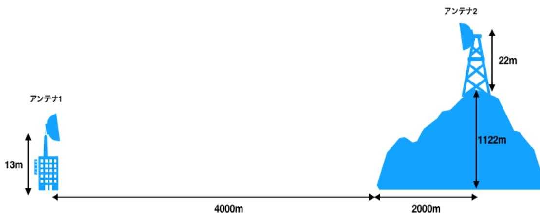
参図 1-7 ルーラル回線シミュレーションモデル-1
