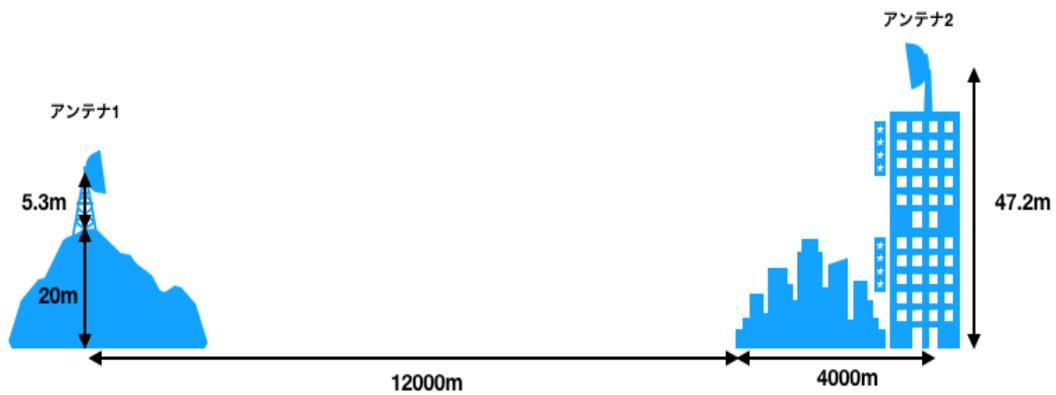
参図 1-10 ルーラル回線シミュレーションモデル-2
