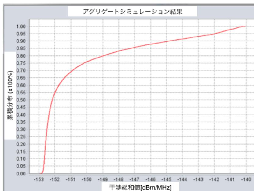
参図 1-13 都市部、100%屋外利用、アンテナ高さ 40m のアグリゲート結果
