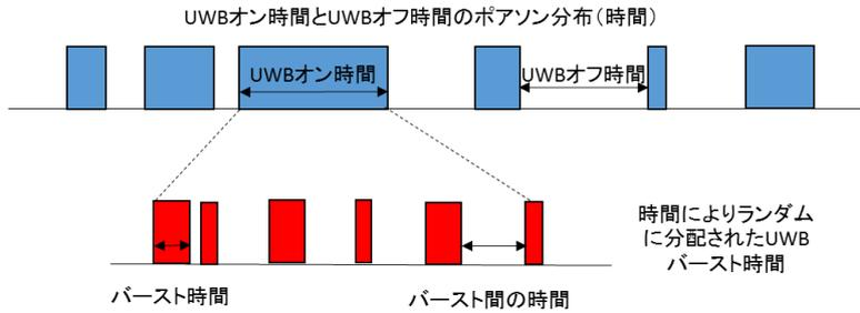
アクティブ時のリンクレート(%) =  $\sum(\text{バースト時間}) / (\text{UWBオン時間})$
