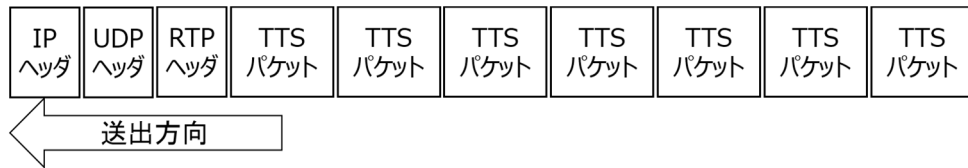
図 4.4-5 IP パケット化された TTS パケット
