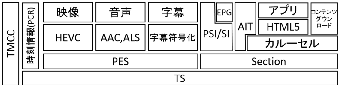
図 4.4-1 MPEG-2 TS 方式のレイヤモデル
