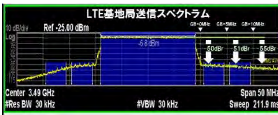
図参 2. 2. 1-2 LTE 基地局の送信スペクトラム例
