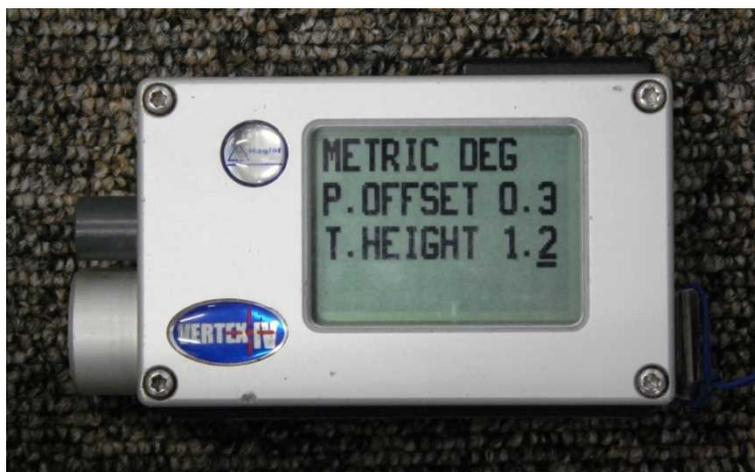
測定の際、測定木に対して十分な距離を取り（樹高以上の距離）、樹冠の頂点を確認できる場所から測定する。トランスポンダーは超音波反射部分を胸高位置に設置する。
