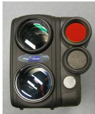
レーザー測高器 2 : バーテックスレーザー (音波計測機能も併せ持つ)
