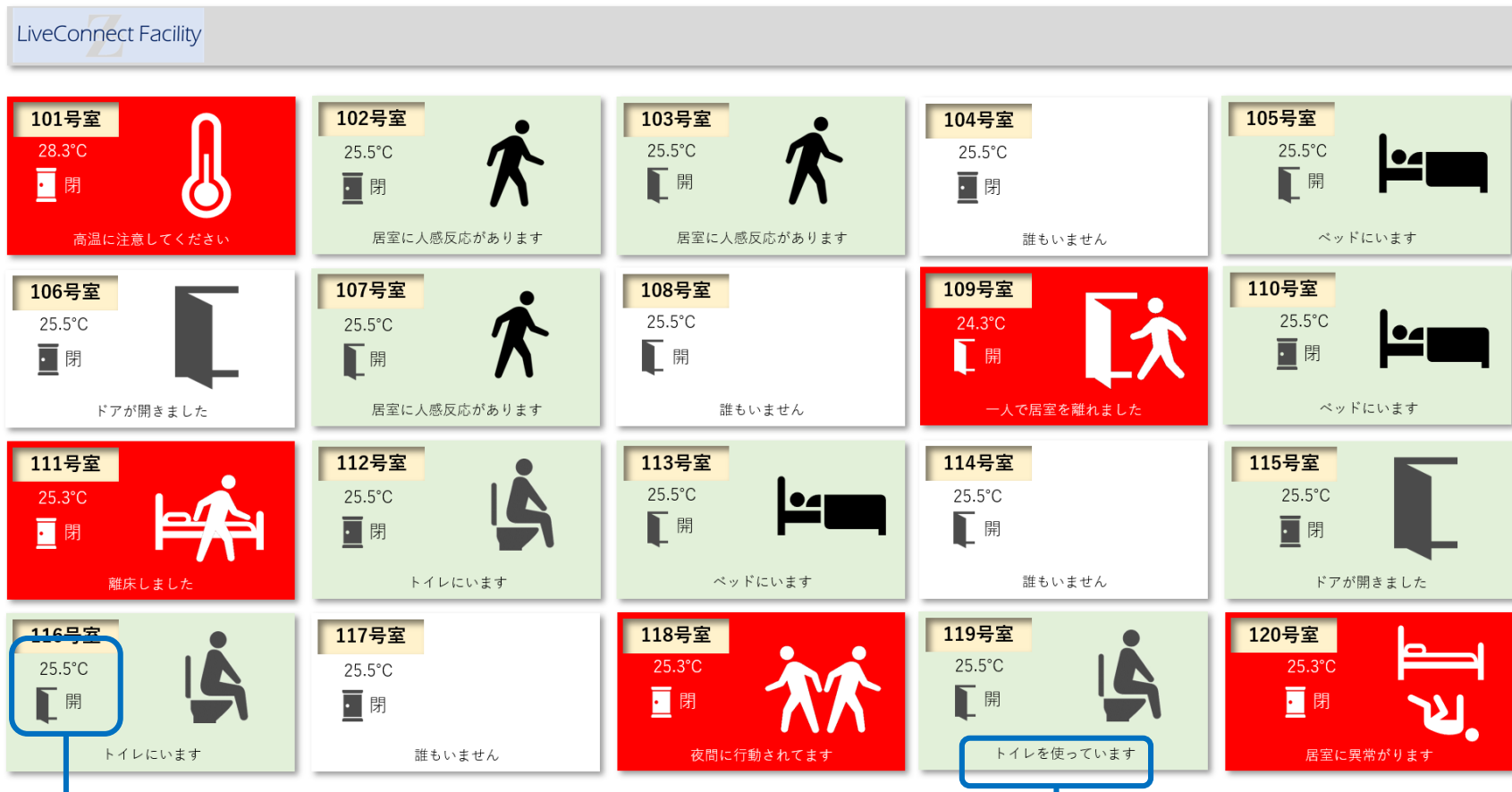
室温・ドアの開閉状態を表示
