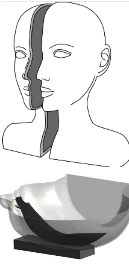
図 5.2 側頭部ファントムの模擬図（上図）及び側頭部評価面（下図） （下図は IEC TR63170 [7] から引用）
