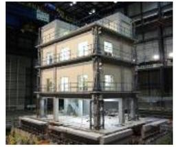
実験に用いた4層RC試験体
