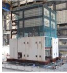
実験に用いた5層鉄骨試験体
