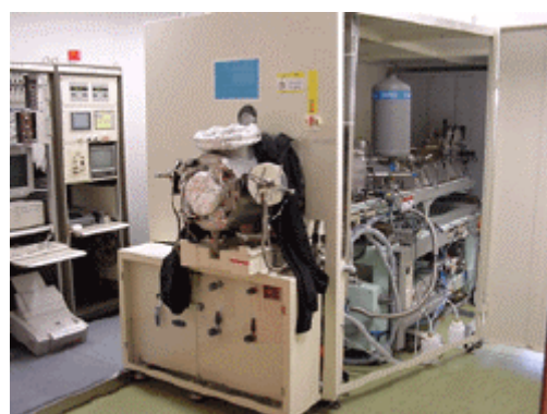
マイクロイオンビーム極微細表面 分析装置 MIB
