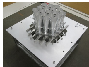
デジタルビーム形成回路＋アレイアンテナ試作(20-30GHz)
