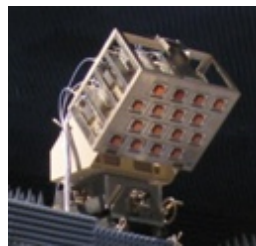
デジタルビーム形成回路＋アレイアンテナ試作(2GHz、100ビーム級)
