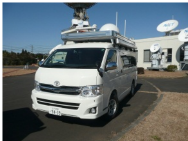
小型車載地球局 →移動しながら 24Mbps通信が可能
