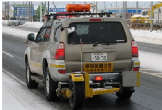
連続路面すべり抵抗測定車 (寒地土木研究所所有)による測定状況
