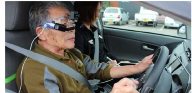
視線を計測するゴーグルを装着し、被験者の操作、自動車の一連の動きを測定する装置を搭載した車両で運転する高齢ドライバー
