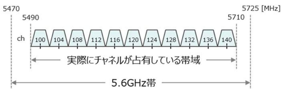
図2. 6. 1 5. 6GHz帯のチャンネル配置
