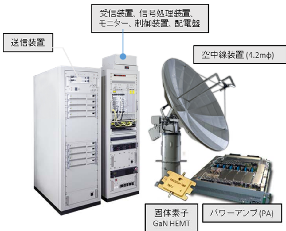
図2.7.4-3 固体化MPレーダーシステムの外観
