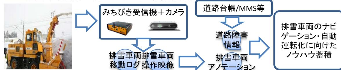
【効果】 排雪車両の運転においては、道路ごとの特徴を把握し、高度な操作技能を必要とする。排雪車両の操作状況と、道路障害情報を組み合わせることで、排雪ノウハウを蓄積し、来年度以降でナビゲーション機能・自動運転化の実用化を検討する。
