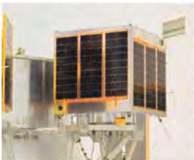
60kg級の6m分解能リモセン衛星(3億円、2年で開発) ほどよし1号 ほどよし3号および4号(2014年打上げ)
