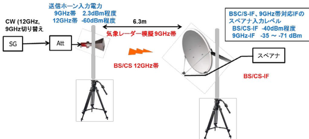
図 3 測定系統図 受信アンテナ込みイメージ妨害抑圧比 S
