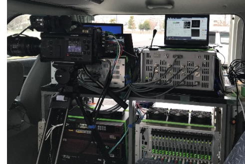
中継車（8Kカメラ、変調器、エンコーダ等）
