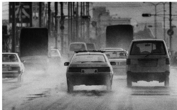
【スパイクタイヤにより削られた舗装道路の粉じんが舞い上がる町並み】
