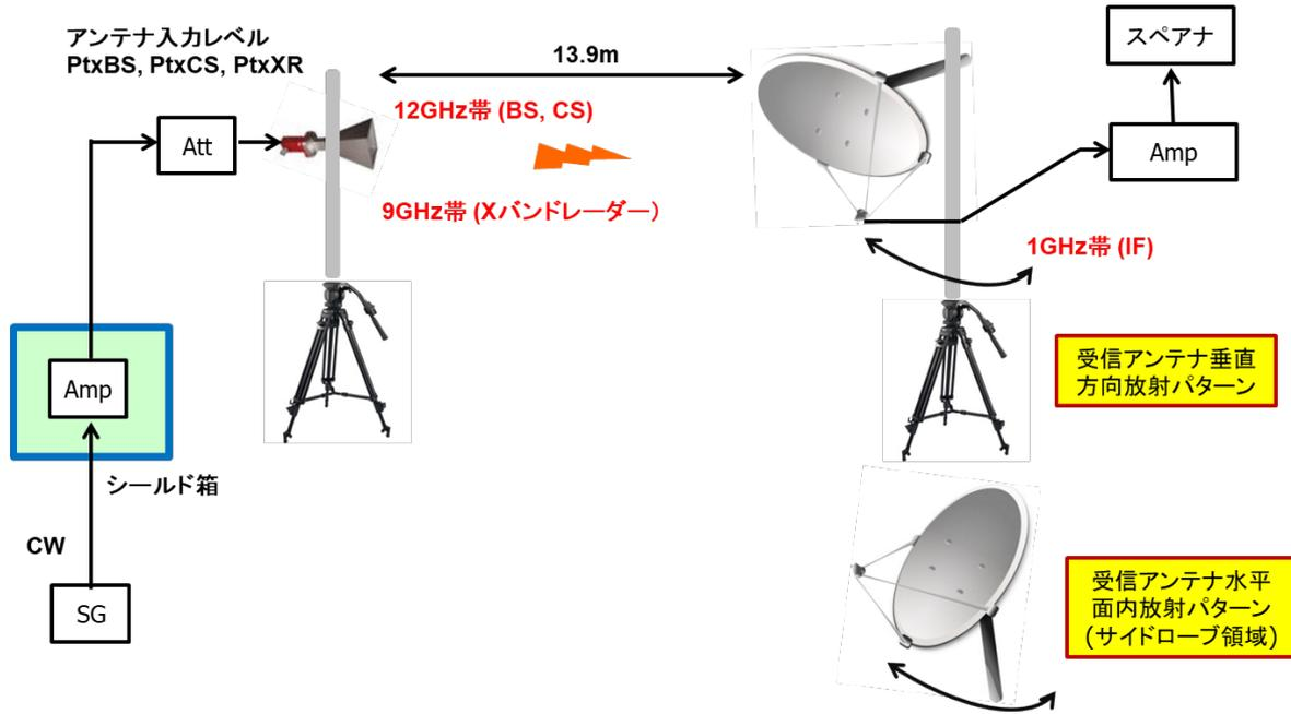
図 5 アンテナ放射パターン測定
