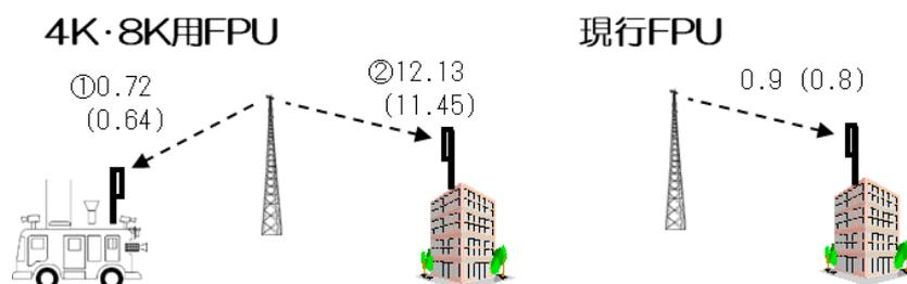
図 14-7 4 K・8 K用 FPU とアマチュア無線月面地球局との離隔距離 (km)
