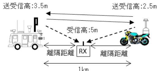
図 12-6 4 K・8 K用 FPU から特定小電力・構内無線局への与干渉モデル
