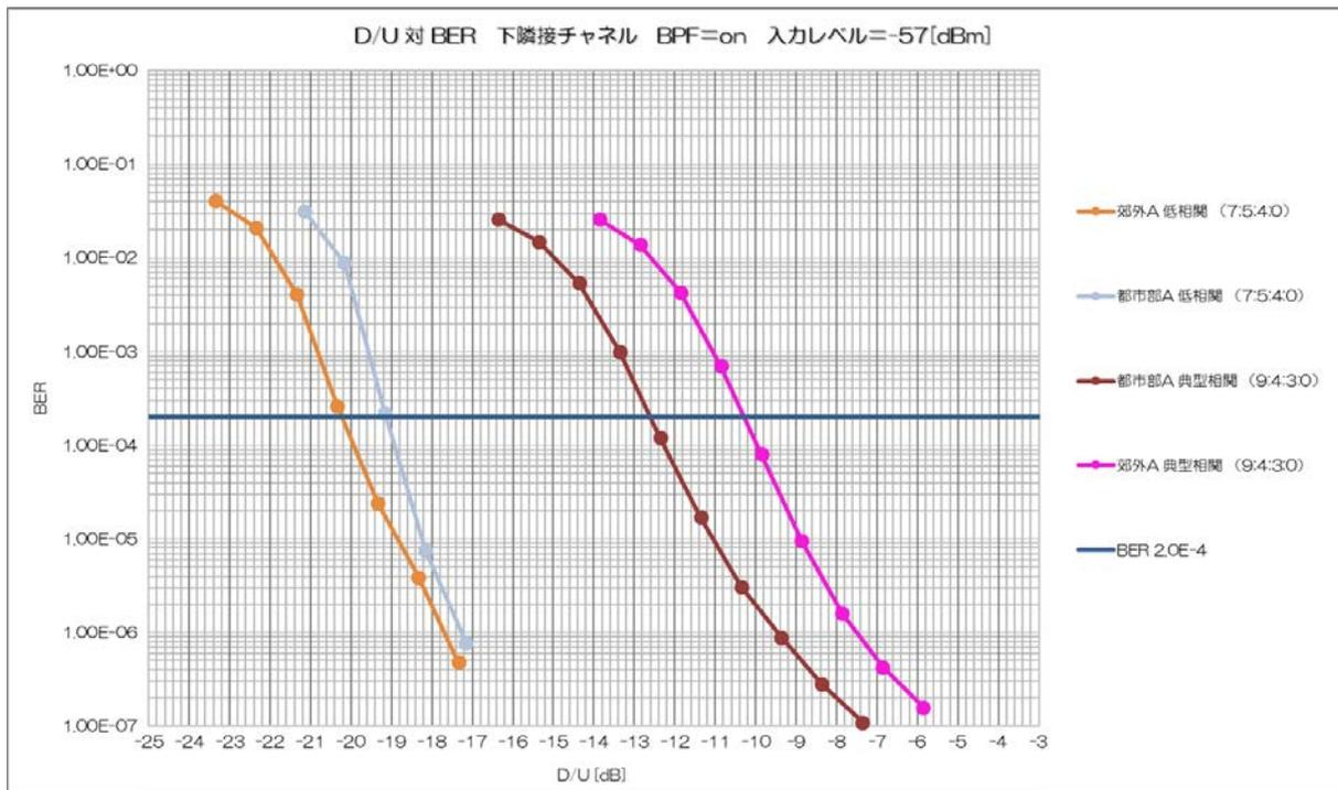
図 10-8 下隣接チャンネル干渉の誤り率特性
