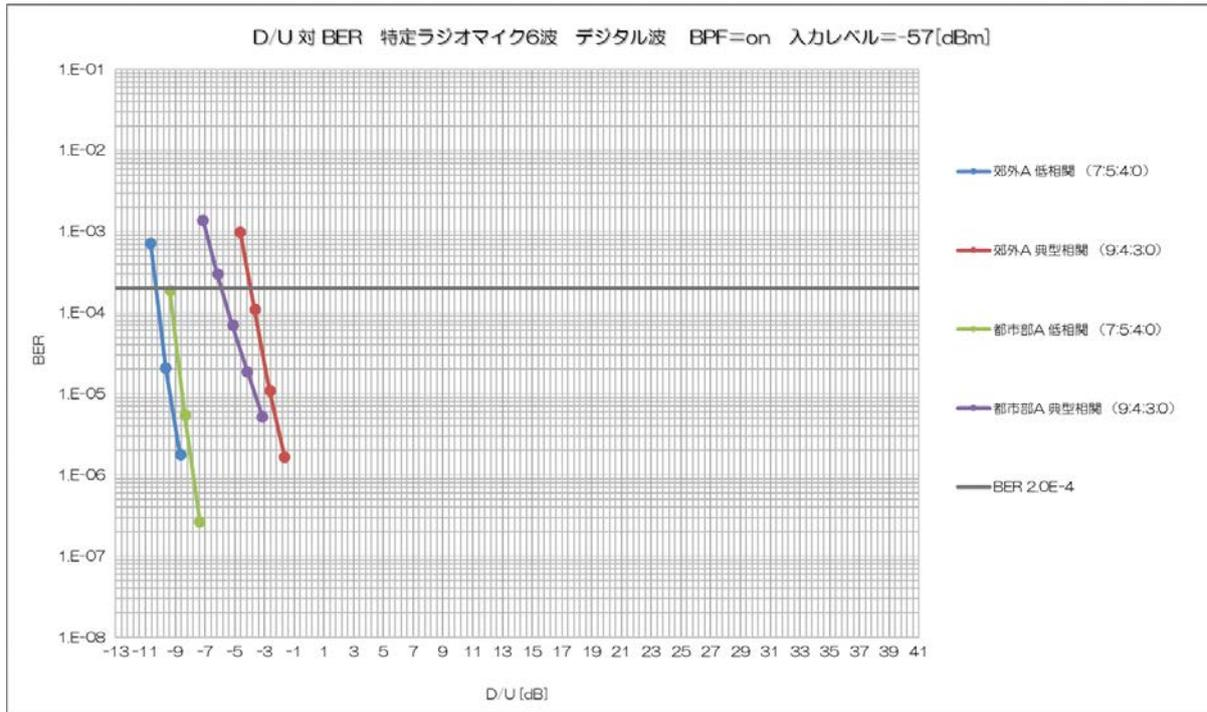
図 11-11 デジタル(DQPSK)6波の場合の D/U 対 BER
