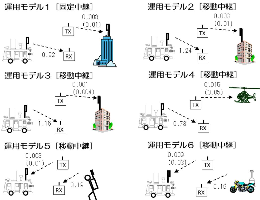
図 12-8（参考） 現行 FPU と特定小電力・構内無線局との離隔距離 (km)
