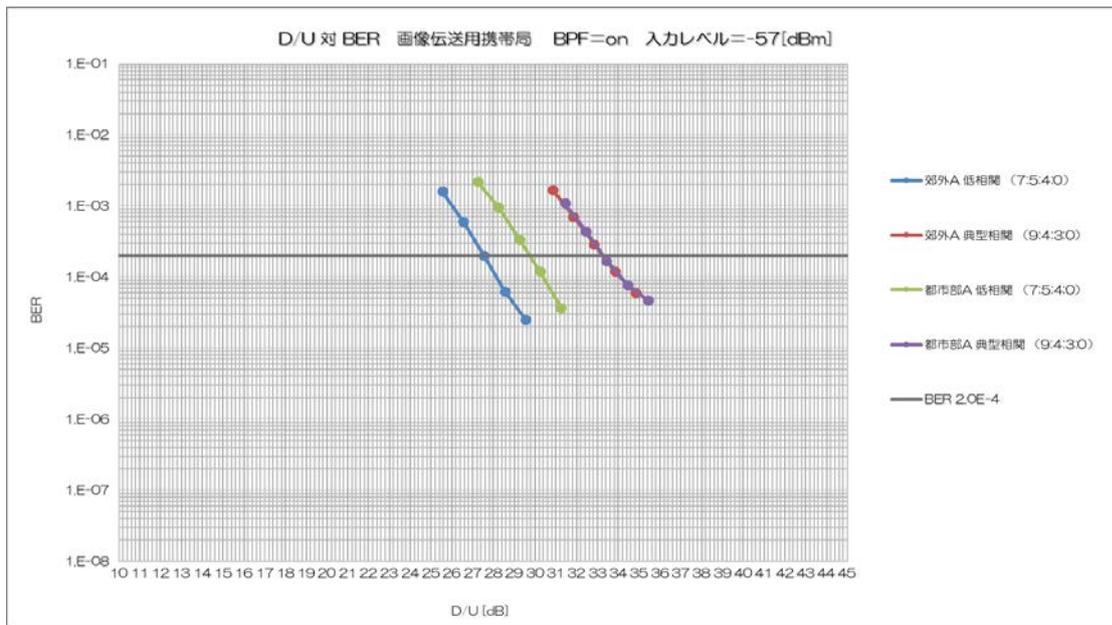
図 13-2 画像伝送用携帯局からの被干渉 (D/U 比・受信 BER)
