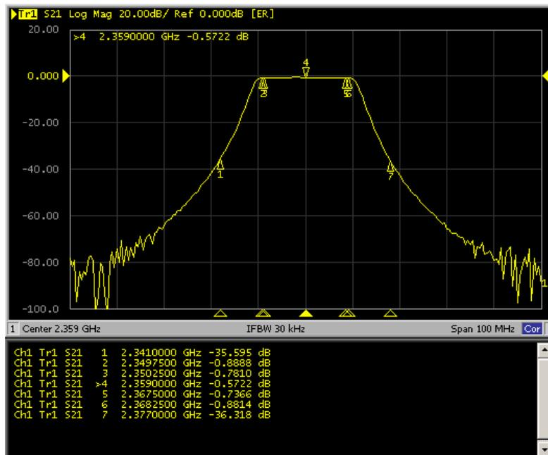
図 10-3 FPU 受信フィルター特性の例
