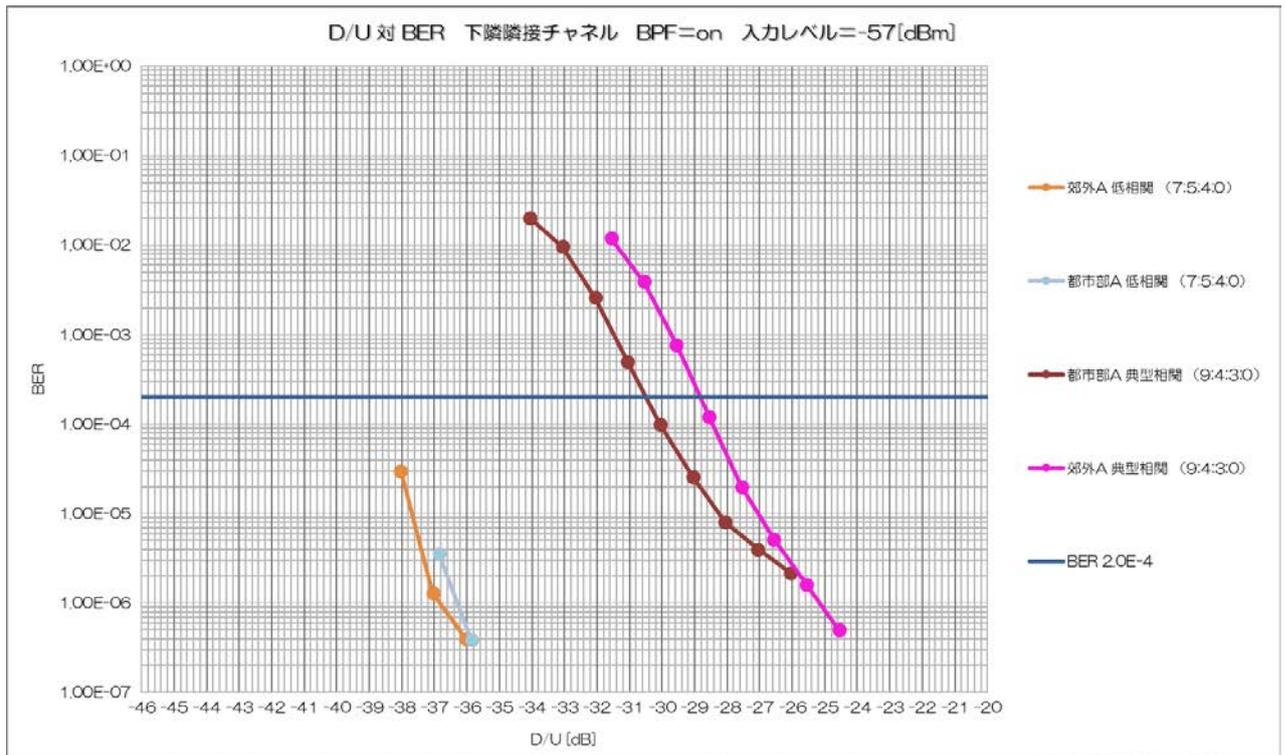
図 10-10 下隣隣接チャンネル干渉の誤り率特性 (受信電力: -57dBm)
