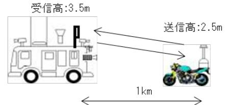
図 9-6 4 K・8 K用 FPU の運用モデル
