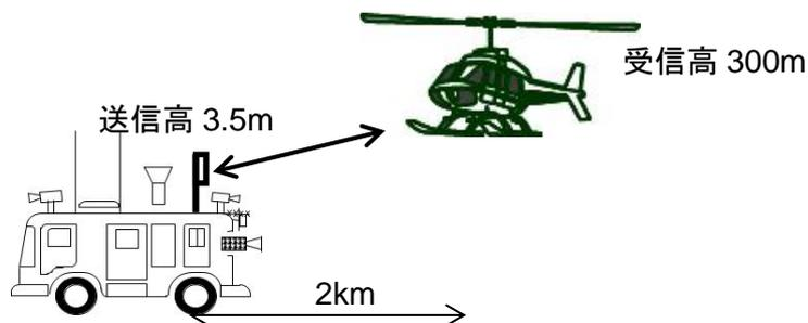
モデル5 [移動中継] 機材を背負い最寄りの中継車に1kmまでの伝送
