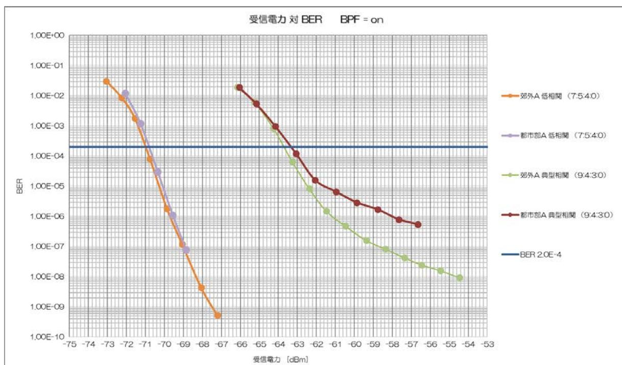
図 10-2 4 K ・ 8 K 用 FPU の受信電力に対する誤り率特性
