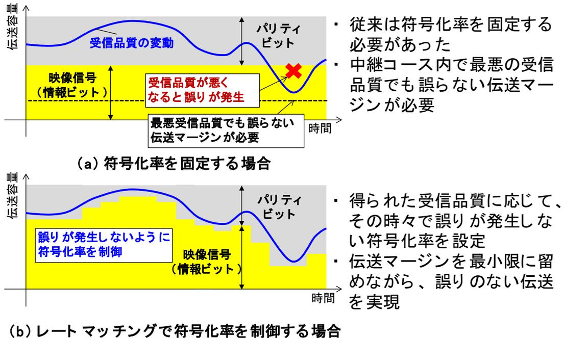
図6-1 レートマッチングの概要
