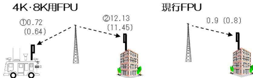
図 17 4 K・8 K用 FPU とアマチュア無線月面地球局との離隔距離 (km)
