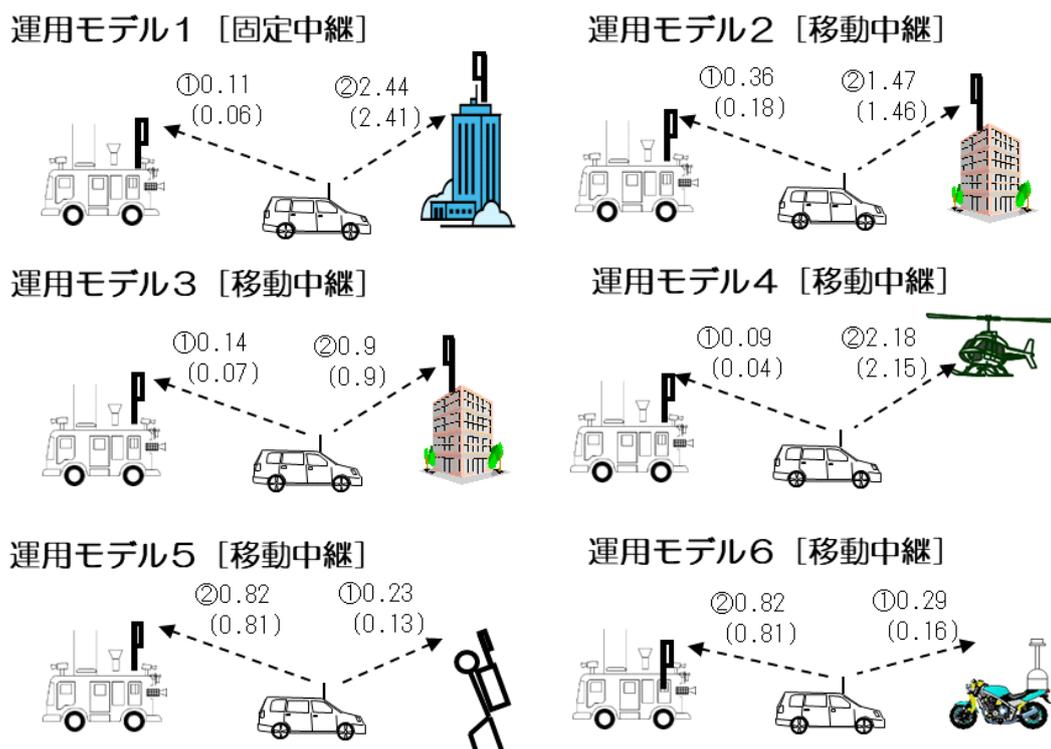
図 14-5 4 K・8 K用 FPU とアマチュア無線移動局との離隔距離 (km)
