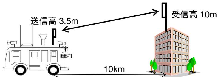
モデル3 [移動中継] 市街地で中継車から受信基地局まで伝搬距離 3km 程度の伝送
