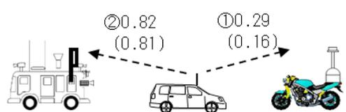
図 16 4 K・8 K用 FPU とアマチュア無線移動局との離隔距離 (km)
