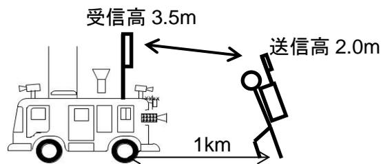
モデル6 [移動中継] バイクから中継車に1kmまでの伝送
