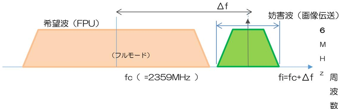
図 13-3 所要 D/U 測定における希望波と妨害波の周波数配置
