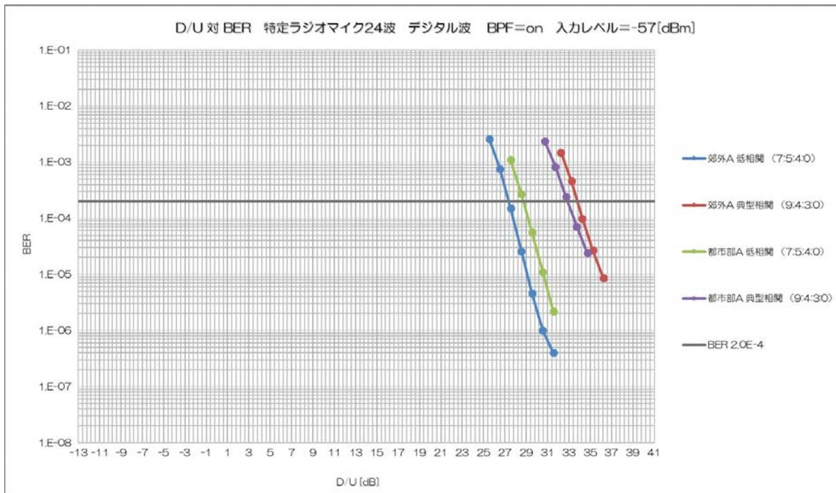
図 11-13 デジタル(DQPSK) 24 波の場合の D/U 対 BER
