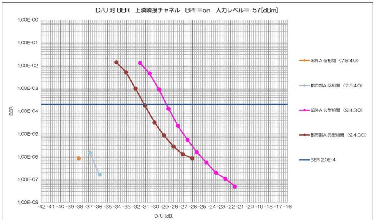
図 10-9 上隣隣接チャンネル干渉の誤り率特性 (受信電力: -57dBm)
