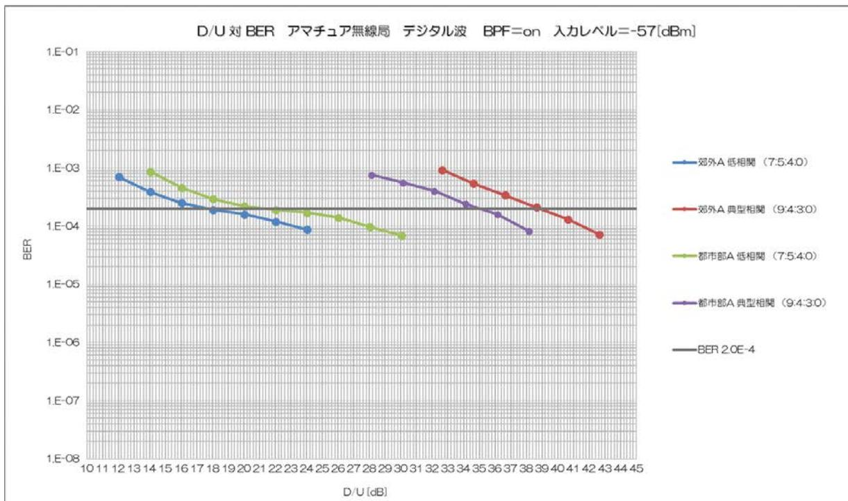
図 14-2 デジタル方式アマチュア無線局からの被干渉における D/U 対 BER
