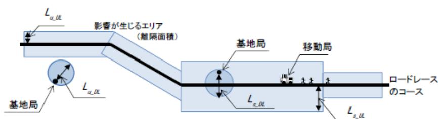
図 15-4 離隔面積の計算モデル
