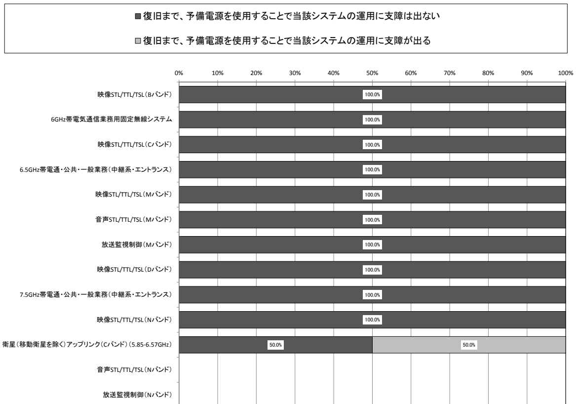
図表一海－４－２４ 「予備電源によるシステムの運用可否」のシステム別比較
