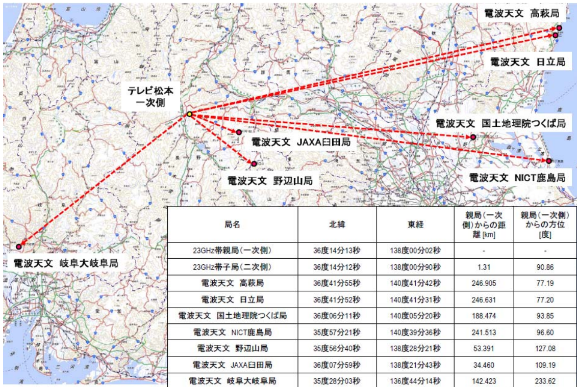
図 4-10 親局における電波天文台への余干渉ルート図
