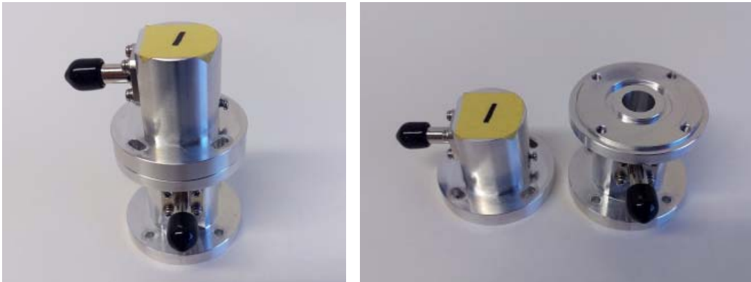
図 4-45 新規 OMT (左 : 組み合わせ状態、右 : 分離状態)
