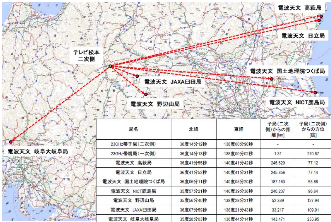
図 4-11 子局における電波天文台への余干渉ルート図
