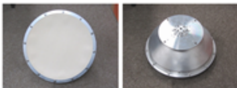
23GHz帯無線伝送システム試験評価器 0.3mφパラボラアンテナ
