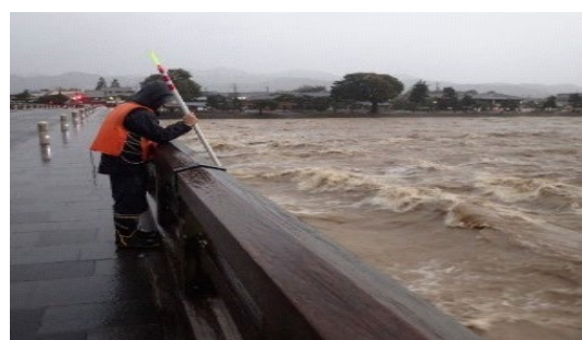
現在の浮子を用いた流量観測(最低5人程度の観測員が必要)
