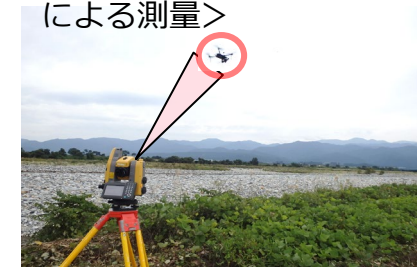
＜TSミラー搭載ドローン による測量＞
