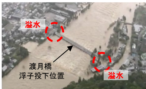
現在の浮子を用いた流量観測(最低5人程度の観測員が必要)
