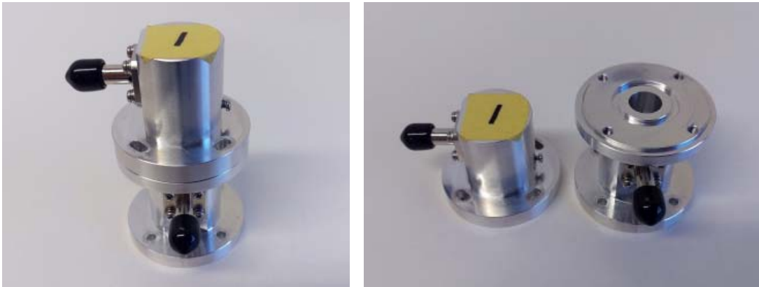
図 4-45 新規 OMT (左 : 組み合わせ状態、右 : 分離状態)
