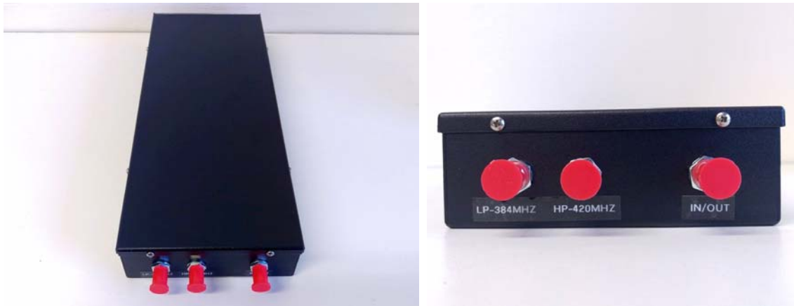
図 4-65 UHF/VHF分波フィルタ外観図 (左：外観、右：入出インターフェース部)
