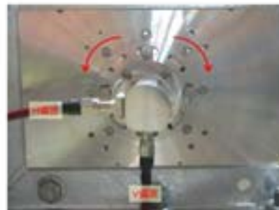
2箇所OMT取り付けボルトを緩め、OMTを左右に廻して調整する。
