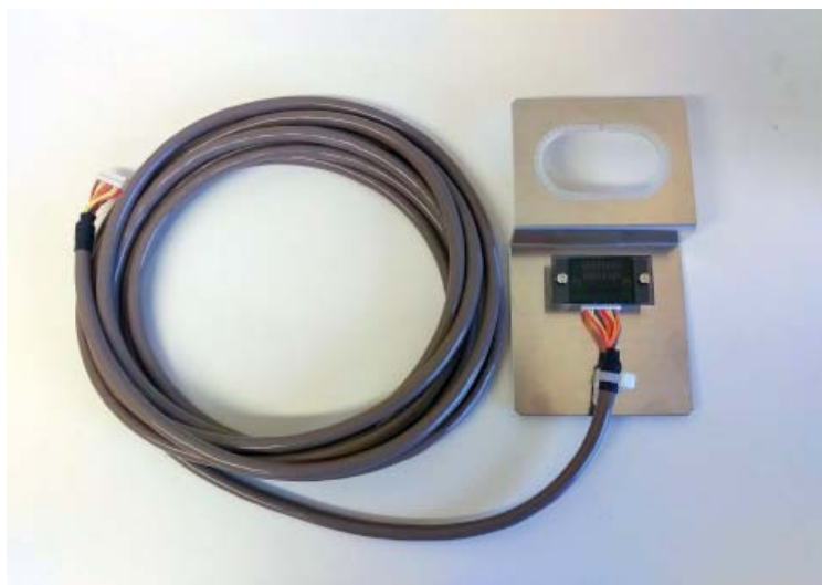
図 4-57 レベルインジケータ外観
