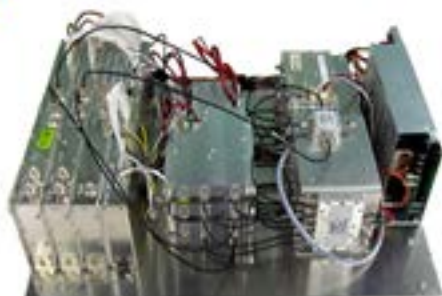
23GHz帯無線伝送システム試験評価器（親局（1次側））
