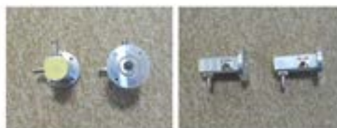
23GHz帯無線伝送システム試験評価器 偏波分離器（OMT）
