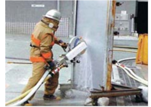
【消防防災科学技術研究推進制度の研究 成果（高水圧駆動カッター）】
