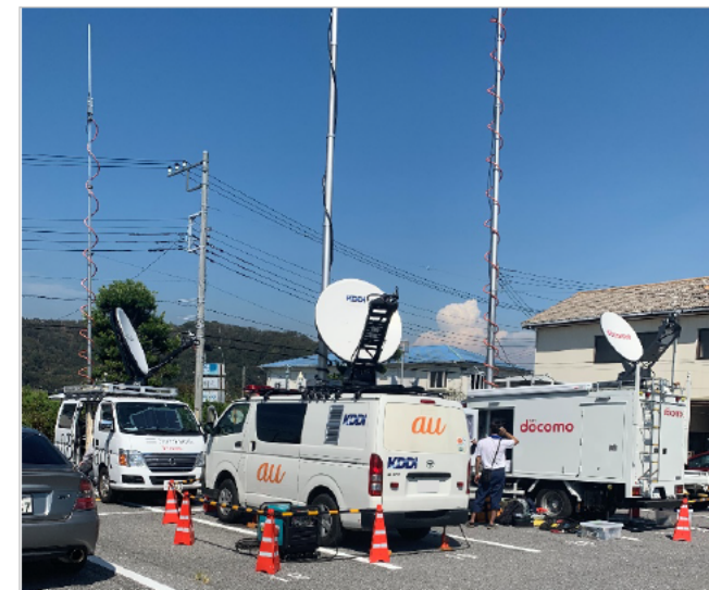
移動基地局車の設置
