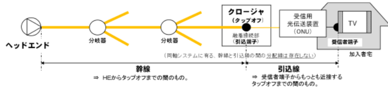
図2-2-3-3 FTTH方式による設備構成例
