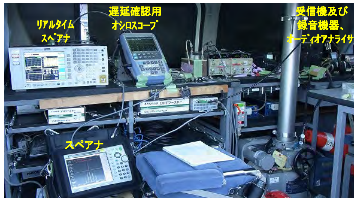
図 3.3-19 車内の測定機器類
