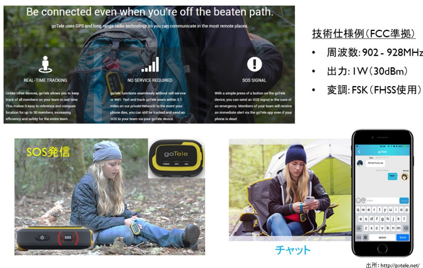
図 1 - 5 FH 方式の小電力無線局の例 (goTele)
