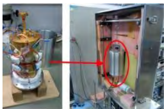
開発した標準器(等温制御型ツインドライカロリメータ)
