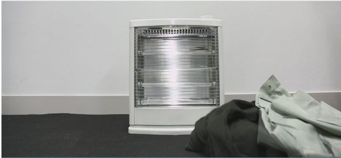
②ストーブ等の暖房機器の周辺は整理整頓し、可燃物を近くに置かないようにしましょう
