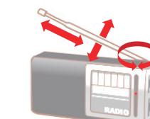
【FMラジオの場合】アンテナの向きを変える
