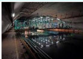
世界最大級の長さ 400m、幅 18m、水深 8mの曳航水槽で、非常に大きなプールで模型船を引っばって性能を計測することで実船の性能を評価する実験施設です。特に、超高速船や大型模型船の試験にも対応が可能です。
