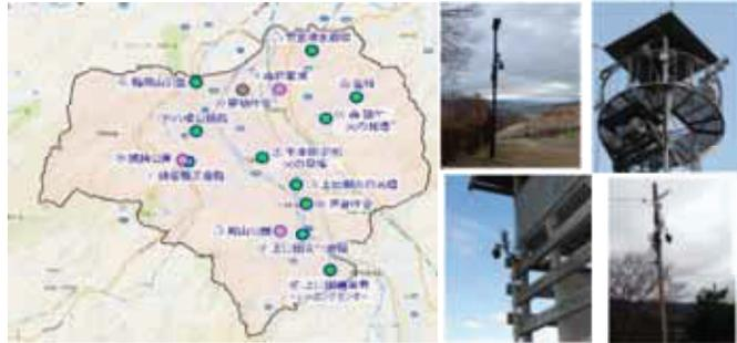
火の見櫓等を活用した市内LoRa通信網の基地局を10力所から14力所に拡充した。LoRa通信エリアマップ作成と地理情報を含めた通信性能評価を実施した。
