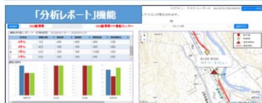
配達員毎の急加速回数、急減速回数、速度超過回数(60km/h以上)及び発生位置等を表示する画面。
