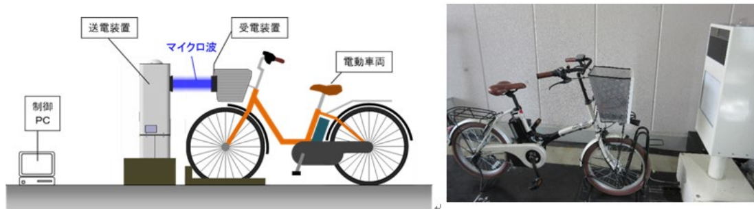
図 1.1.4 電動車両向け空間伝送型ワイヤレス電力伝送システムの社会実証実験（イ）
