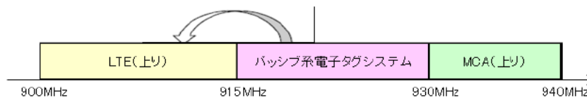
図参 4.3.3 パッシブ系電子タグシステムから携帯電話システム（LTE）上りへの影響
