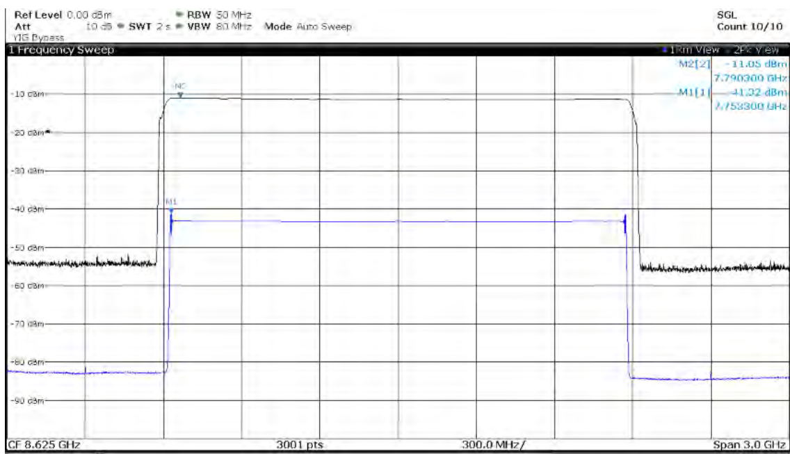
図 3-5 UWB 無線システムの送信波形 (F3N) (中心周波数: 8625MHz、占有帯幅: 1732MHz)
