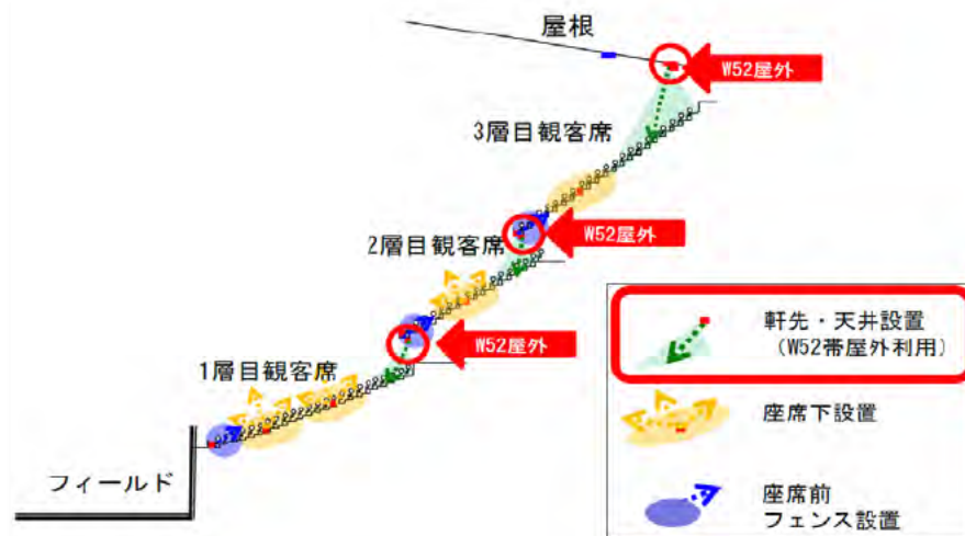
新国立競技場における高密度Wi-Fi - アクセスポイントの設置位置
