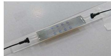
試作したアンテナ電極
