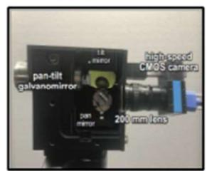
1km先の望遠撮影を可能とした超望遠振動トラッキングカメラ
