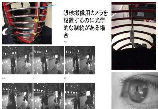
眼球撮像用カメラを設置するのに光学的な制約がある場合
